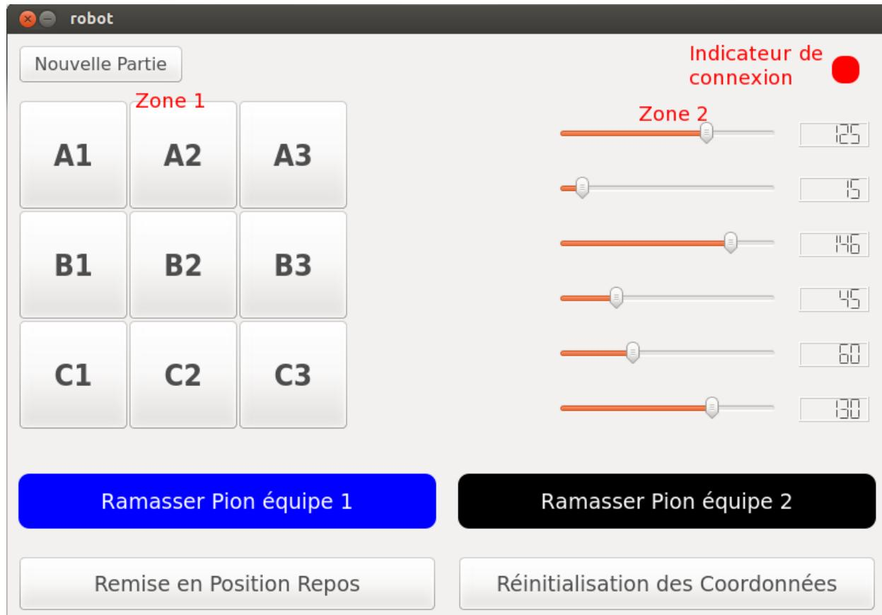
La zone 1 correspond à la zone de jeu en tant que telle. L'appui d'un bouton provoque le déplacement du robot à la position référencée pour ce bouton (pour l'instant ces positions ne sont pas modifiables sans toucher au code, mais c'est un axe de développement prévu).
